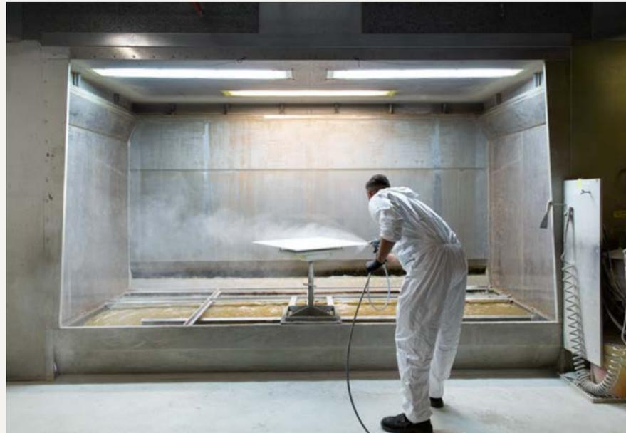
Nach präzisiertem, auf Zehntelmillimeter genauem Digitalzuschnitt erfolgt die Lackierung. Jede Füllung der Front wird von allen Seiten bearbeitet. Bis in die seitliche Nut hinein muss der Farbauftrag exakt vorgenommen werden, um späteres Eindringen von Feuchtigkeit zu vermeiden.
